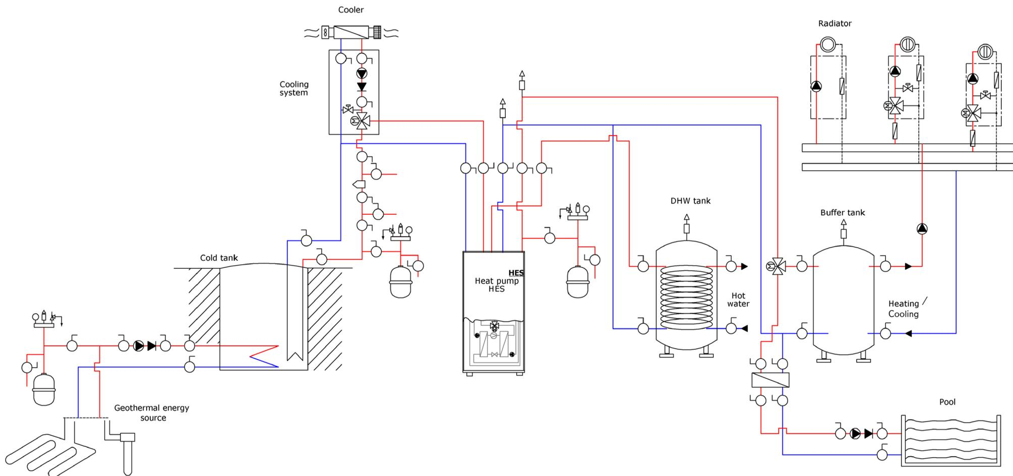
Схема подключения теплового насоса HES ECO-cool для отопления, горячего водоснабжения (ГВС), подогрева воды в бассейне, пассивного охлаждения фанкойлами, бака холода и утилизации тепла.
