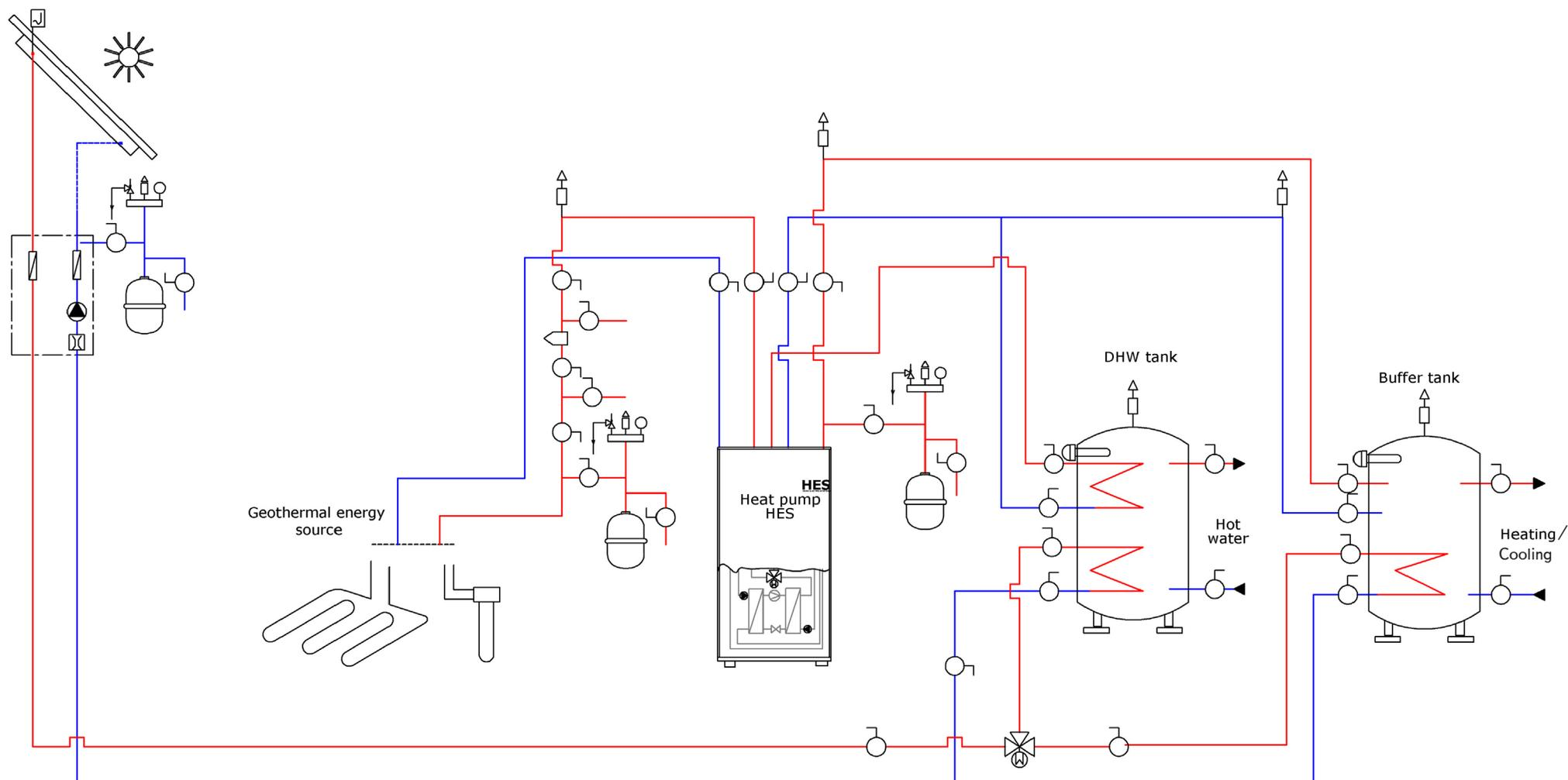
Схема подключения теплового насоса HES ECO-cool для отопления, горячего водоснабжения (ГВС), пассивного охлаждения фанкойлами, подогрева воды в бассейне и дополнительного источника энергии в виде солнечного коллектора.
