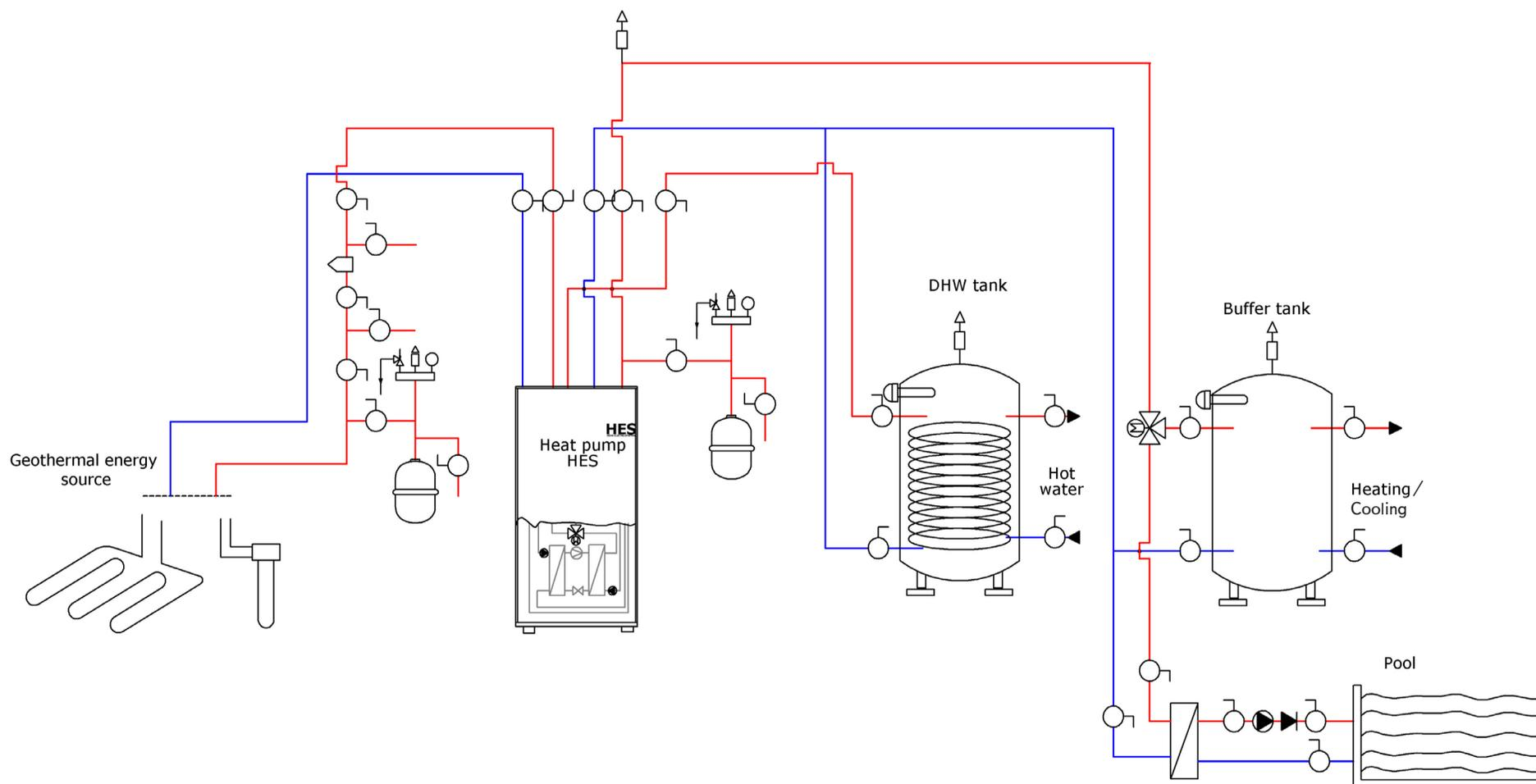
Схема подключения теплового насоса HES ECO-cool для отопления, горячего водоснабжения (ГВС) и дополнительного источника энергии в виде солнечного коллектора.
