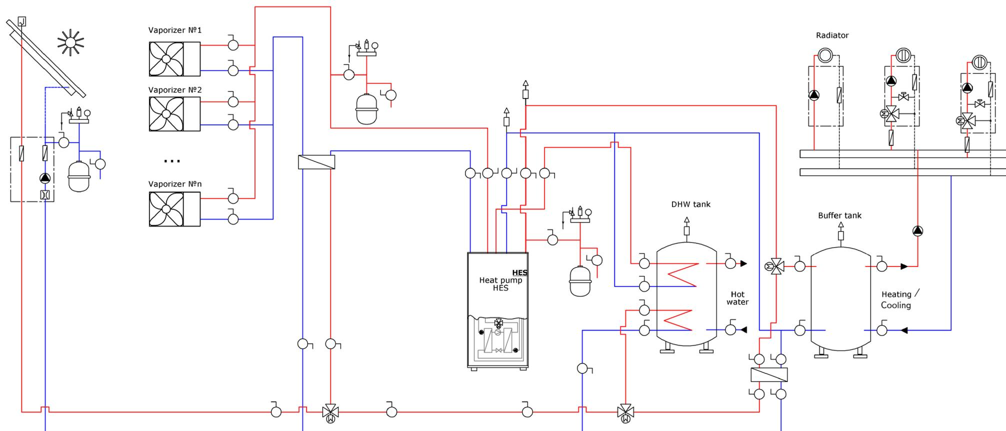
Схема подключения теплового насоса HES ECO-cool для отопления, горячего водоснабжения (ГВС), дополнительного источника энергии в виде солнечного коллектора и загрузки бака холода от солнца.
