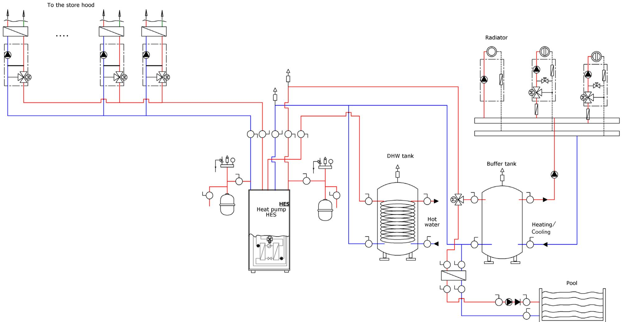
Схема подключения теплового насоса HES ECO-cool для отопления, горячего водоснабжения (ГВС), подогрева воды в бассейне, утилизации тепла серверные/ЦОД, сброс отработанной воды, и т.д.
