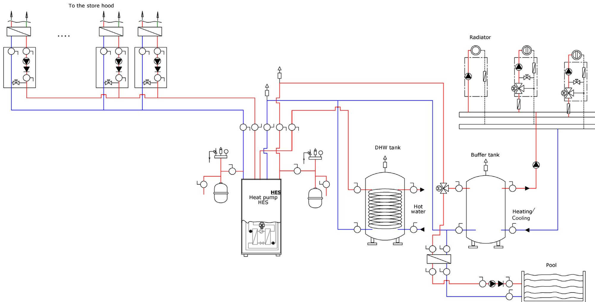
Схема подключения теплового насоса HES ECO-cool для отопления, горячего водоснабжения (ГВС) и подогрева воды в бассейне.
