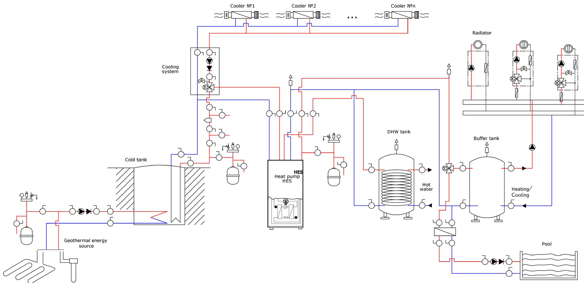
Схема подключения теплового насоса HES ECO-cool для отопления, горячего водоснабжения (ГВС), подогрева воды в бассейне, утилизации тепла, пассивного охлаждения, бака холода, геотермального контура и теплообменников.
