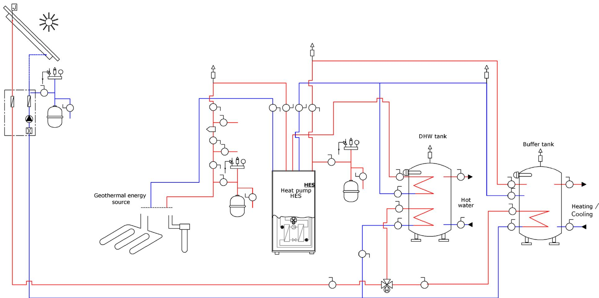
Схема подключения теплового насоса HES ECO-cool для отопления, горячего водоснабжения (ГВС), пассивного охлаждения, подогрева воды в бассейне, пассивного охлаждения фанкойлами и дополнительного источника энергии в виде солнечного коллектора.
