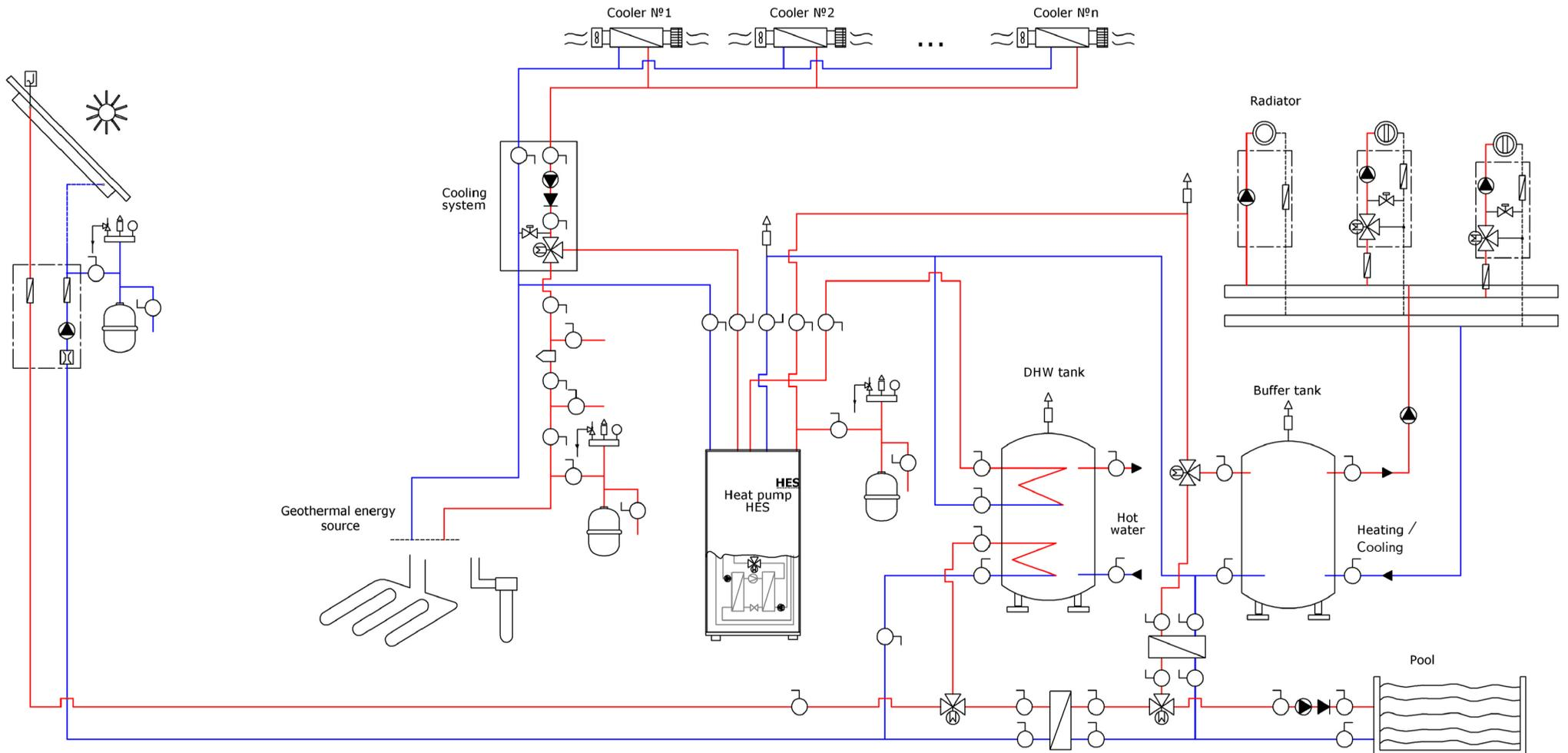
Схема подключения теплового насоса HES ECO-cool для отопления, горячего водоснабжения (ГВС), дополнительного источника энергии в виде солнечного коллектора, подогрева воды в бассейне, пассивного охлаждения фанкойлами, утилизации тепла и осушения.
