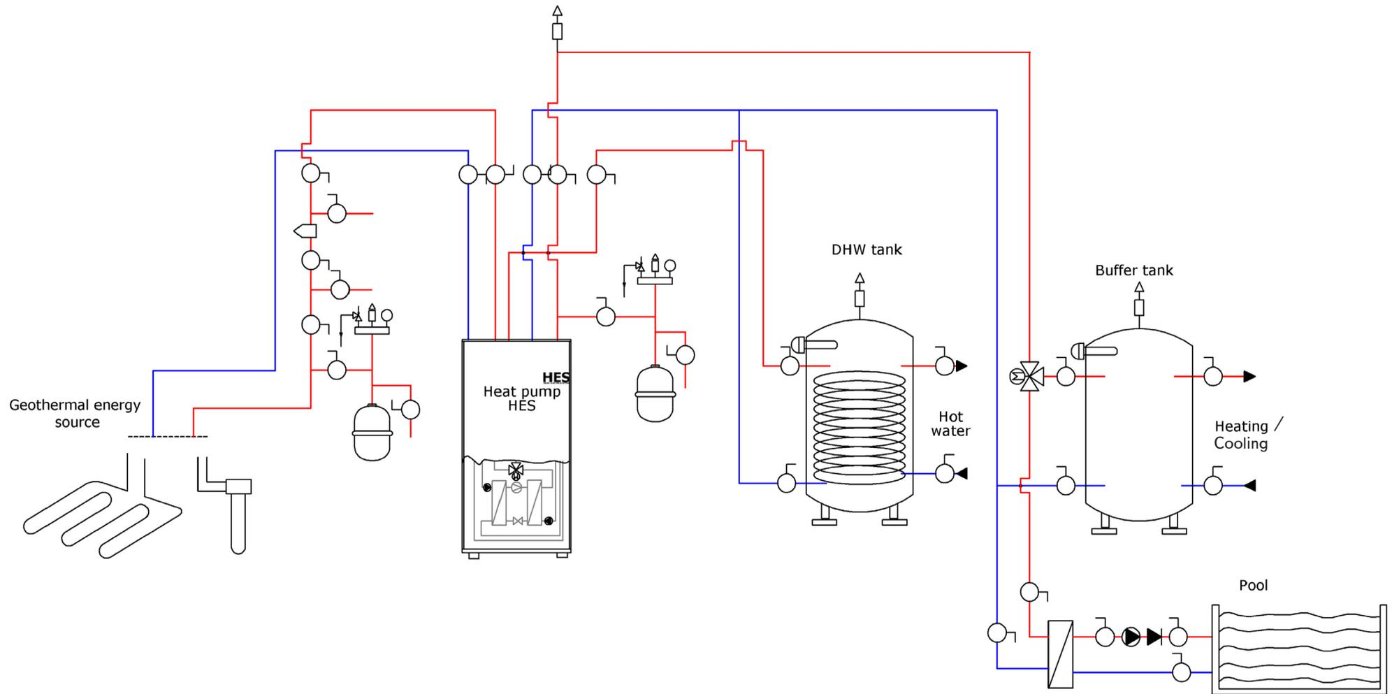
Схема подключения теплового насоса HES ECO-cool для отопления, горячего водоснабжения (ГВС) и дополнительного источника энергии в виде солнечного коллектора.
