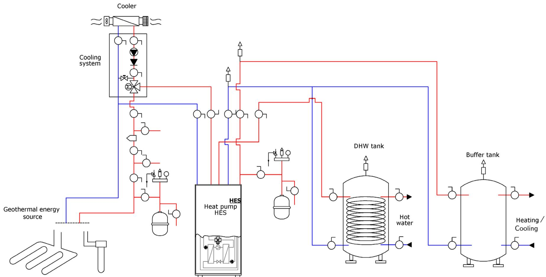
Схема подключения теплового насоса HES ECO-cool для отопления, горячего водоснабжения (ГВС).
