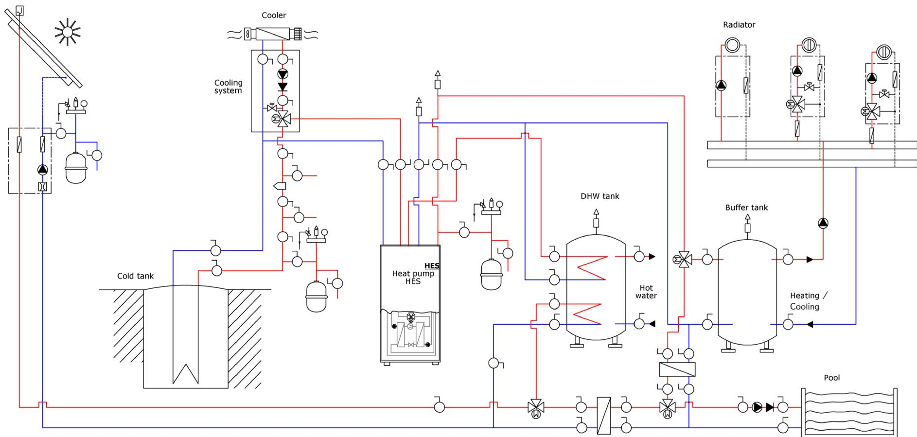
Схема подключения теплового насоса HES ECO-cool для отопления, горячего водоснабжения (ГВС) и пассивного охлаждения фанкойлами.
