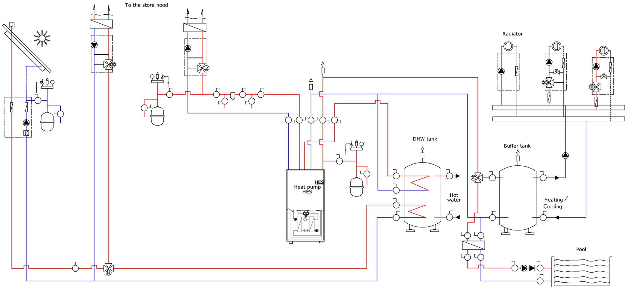
Схема подключения теплового насоса HES ECO-cool для отопления, горячего водоснабжения (ГВС), подогрева воды в бассейне, бака холода и геотермального контура.
