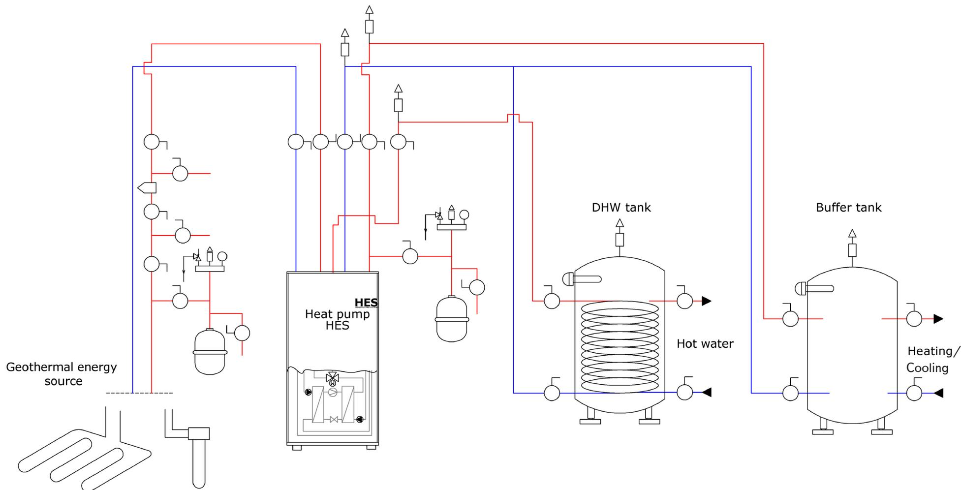
Схема подключения теплового насоса HES ECO-cool для отопления, горячего водоснабжения (ГВС) и пассивного охлаждения фанкойлами.
