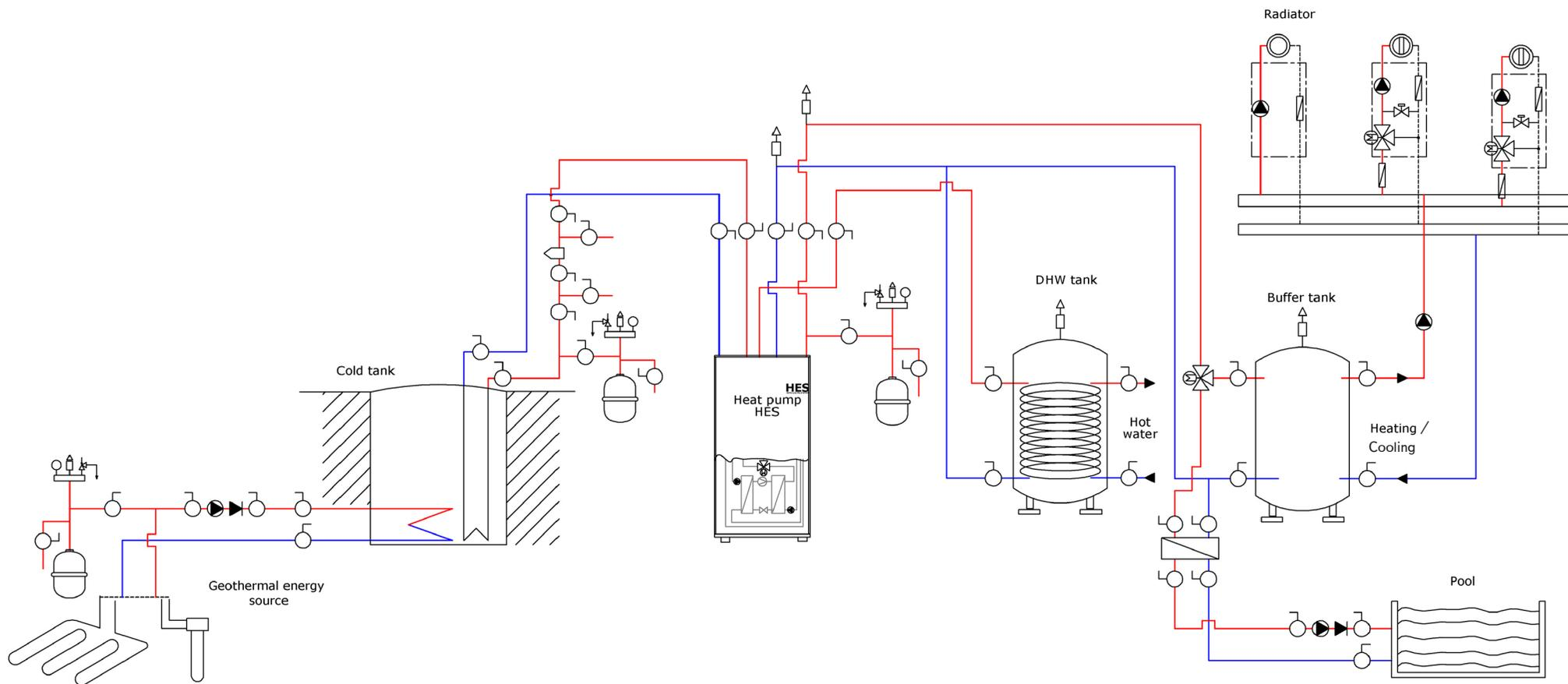
Схема подключения теплового насоса HES ECO-cool для отопления, горячего водоснабжения (ГВС), подогрева воды в бассейне, пассивного охлаждения фанкойлами и бака холода.
