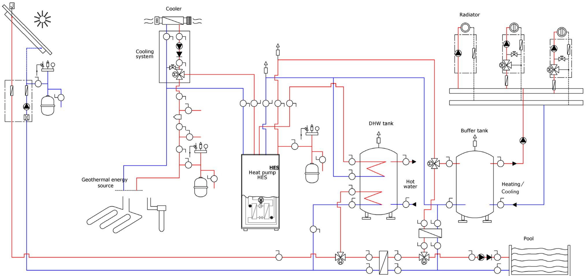
Схема подключения теплового насоса HES ECO-cool для отопления, горячего водоснабжения (ГВС), дополнительного источника энергии в виде солнечного коллектора, системы осушения и охлаждения воздуха, сброса избытков тепла от солнца.
