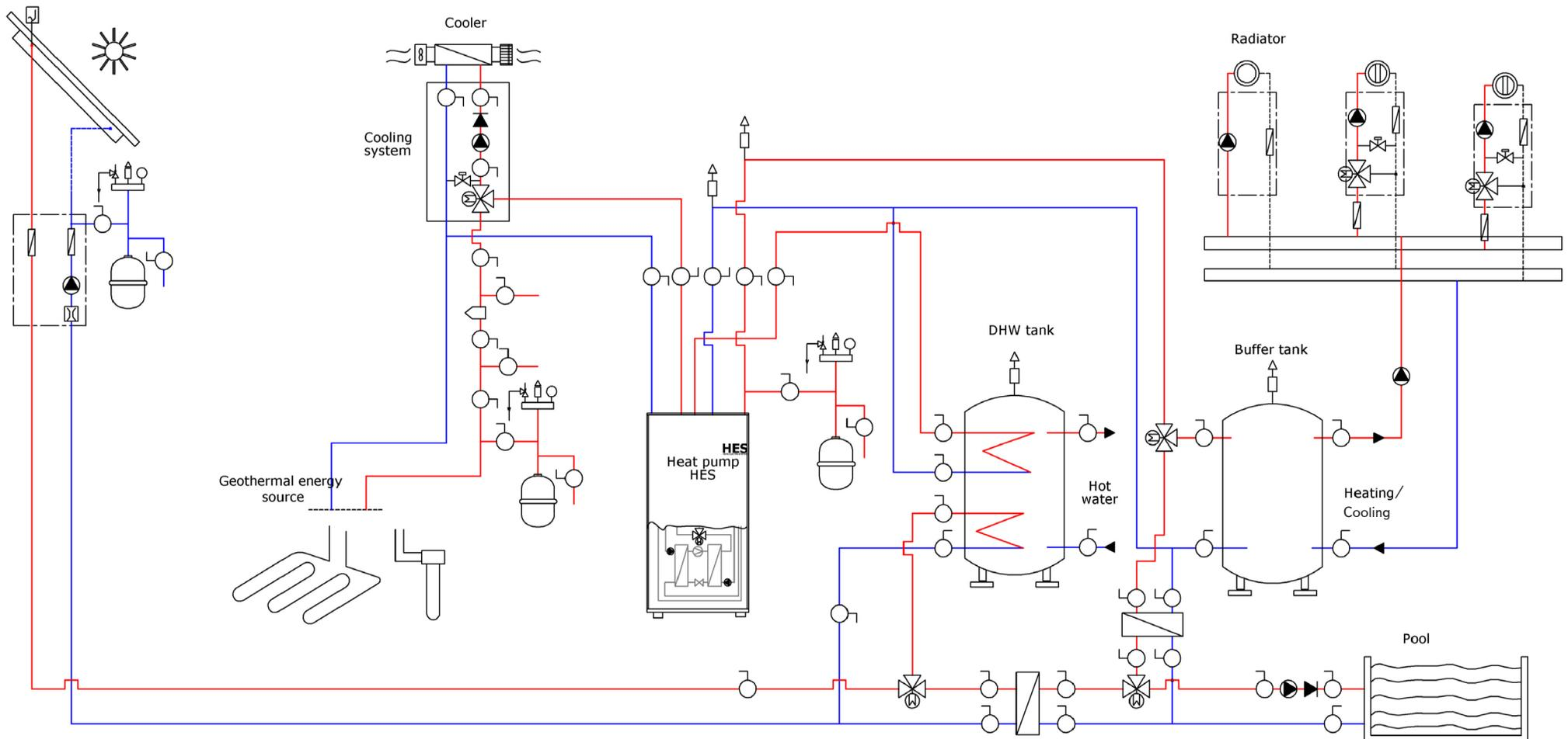
Схема подключения теплового насоса HES ECO-cool для отопления, горячего водоснабжения (ГВС) и пассивного охлаждения фанкойлами и и активного охлаждения при подключении к буферному баку.
