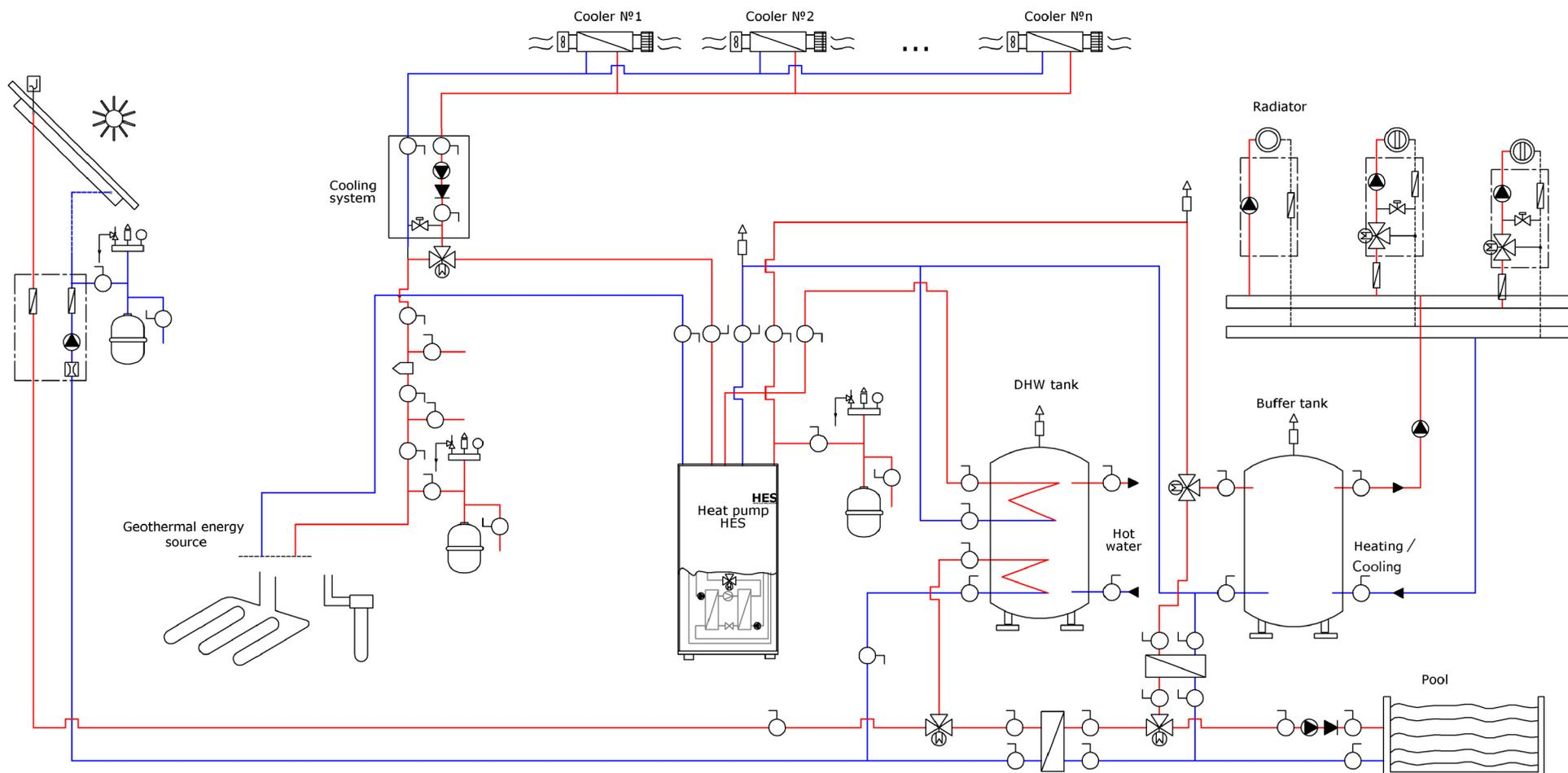
Схема подключения теплового насоса HES ECO-cool для отопления, горячего водоснабжения (ГВС), дополнительного источника энергии в виде солнечного коллектора, подогрева воды в бассейне и пассивного охлаждения фанкойлами.
