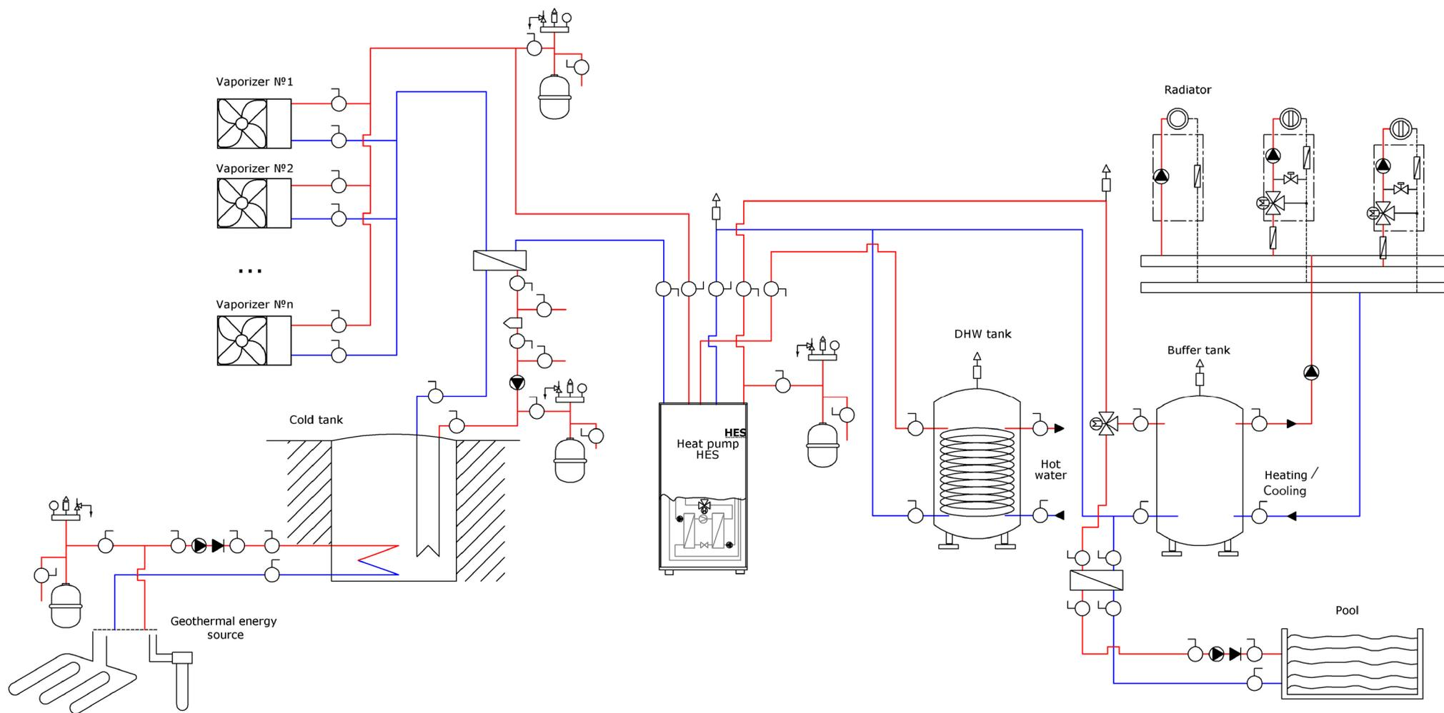
Схема подключения теплового насоса HES ECO-cool для отопления, горячего водоснабжения (ГВС), подогрева воды в бассейне, пассивного охлаждения и утилизации тепла от ТЦ/ЦОД/вытяжки и т.д
