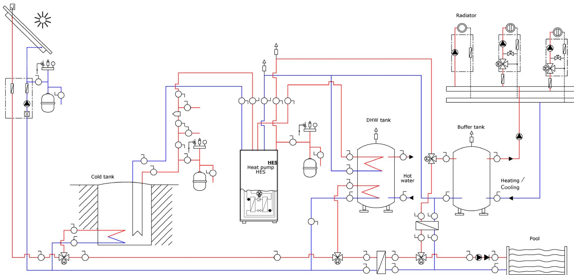
Схема подключения теплового насоса HES ECO-cool для отопления, горячего водоснабжения (ГВС), дополнительного источника энергии в виде солнечного коллектора, подогрева воды в бассейне, пассивного охлаждения фанкойлами.
