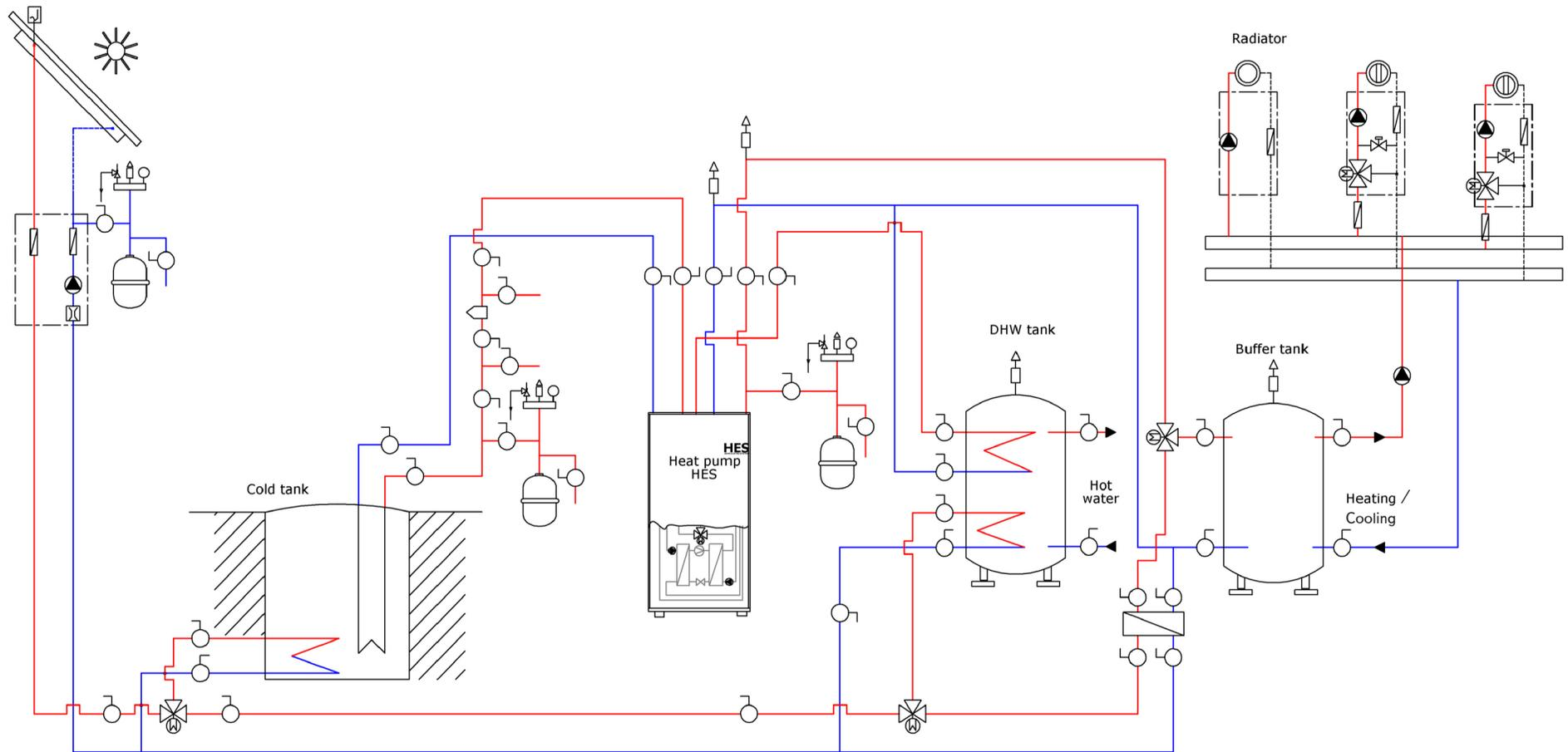
Схема подключения теплового насоса HES ECO-cool для отопления, горячего водоснабжения (ГВС), подогрева воды в бассейне, дополнительного источника энергии в виде солнечного коллектора и загрузки бака холода от солнца.
