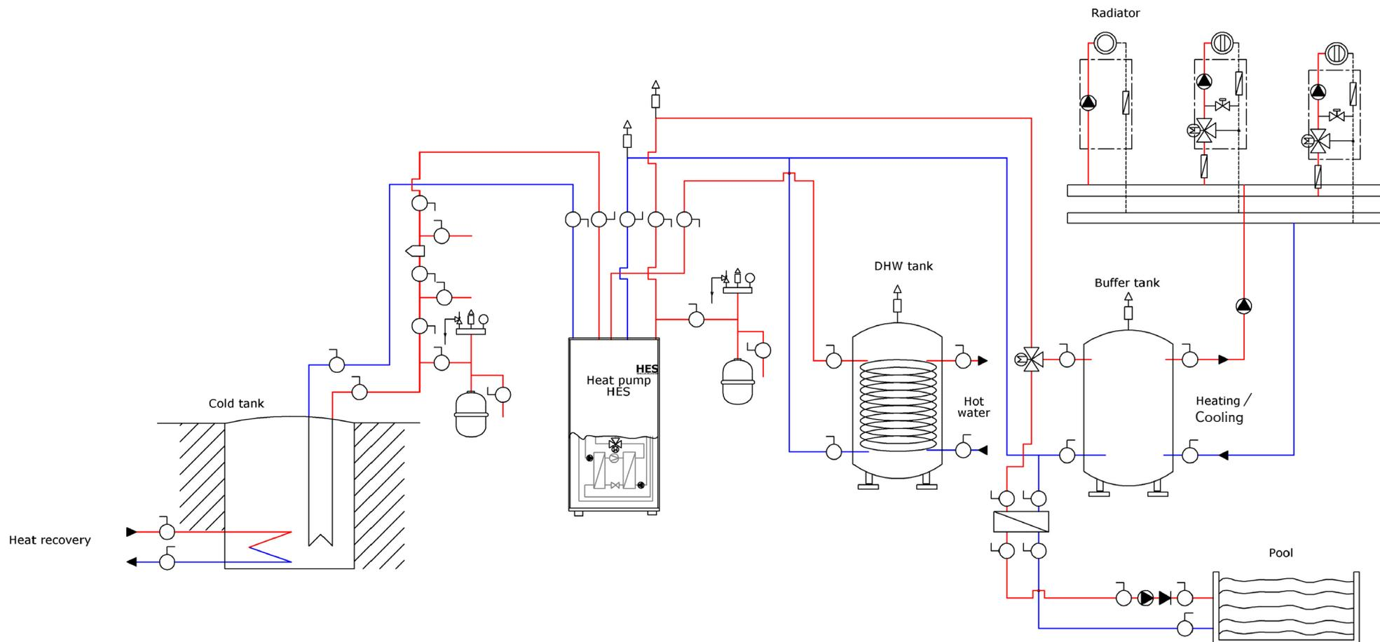
Схема подключения теплового насоса HES ECO-cool для отопления, горячего водоснабжения (ГВС), подогрева воды в бассейне, утилизации тепла, дополнительного источника энергии в виде солнечного коллектора и пассивного охлаждения.
