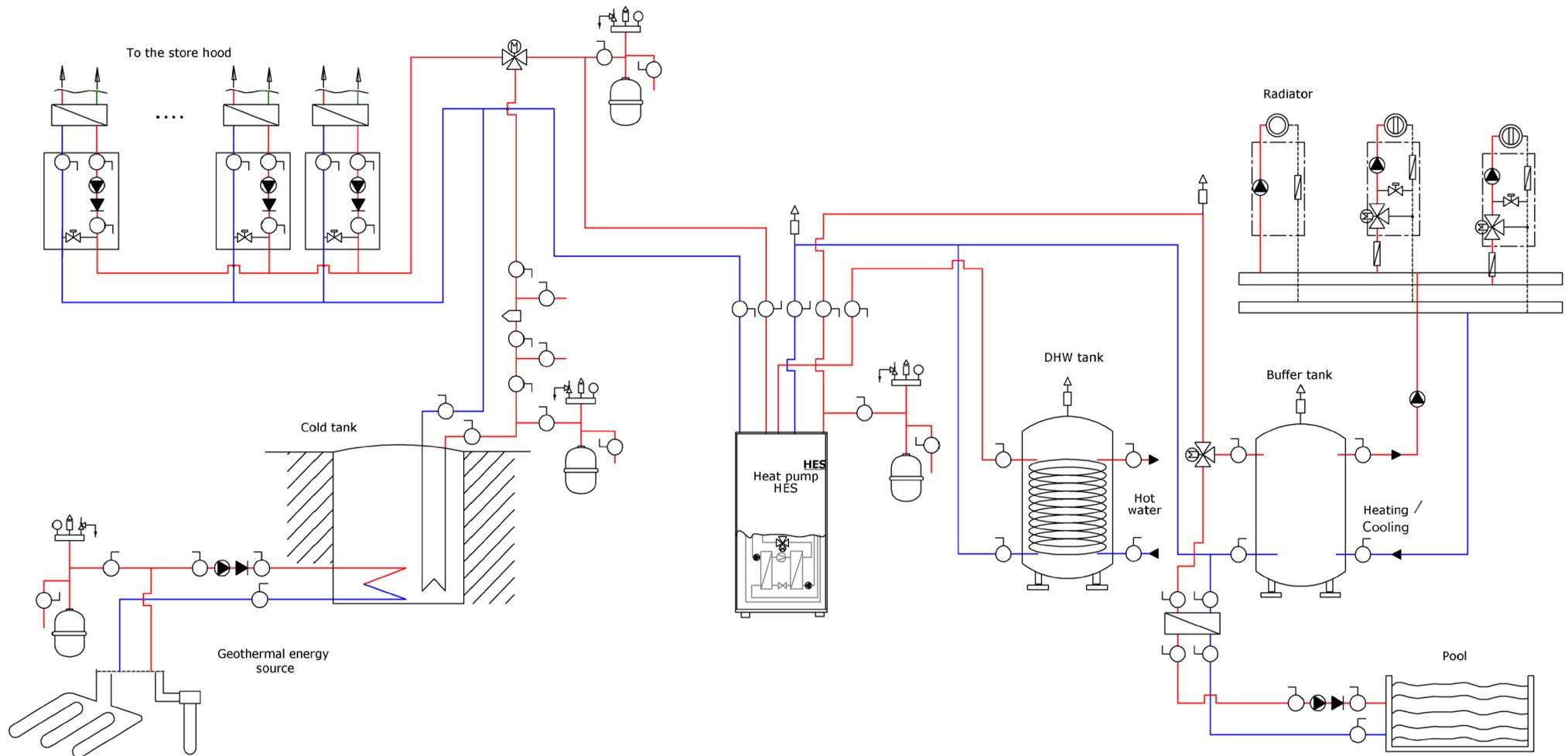
Схема подключения теплового насоса HES ECO-cool для отопления, горячего водоснабжения (ГВС), подогрева воды в бассейне, утилизации тепла, пассивного охлаждения, бака холода и геотермального контура.
